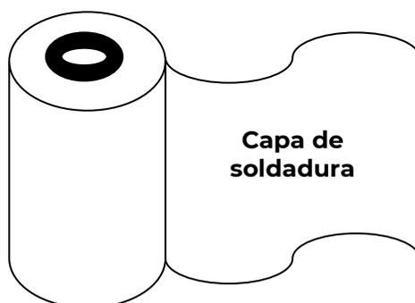
Figura 1 – Localización de la capa de soldadura de la película de AMISTYLE
